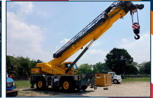
Grúa Grove RT de 100 tn.
